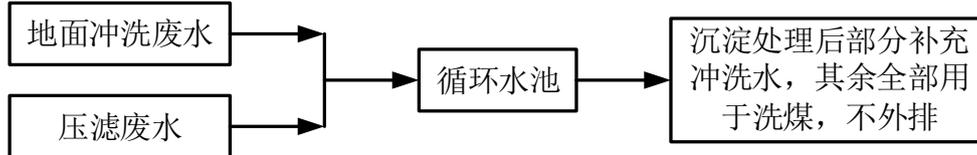
图 4 废水治理流程示意图
