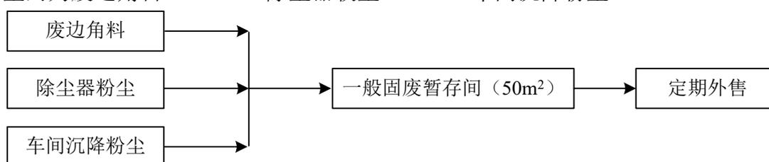
图 6 固废治理流程示意图
